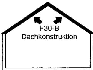
Die §§ 32 Abs. 1 NBauO und 11 Abs. 1 DVNBauO fordern für die Dachhaut Widerstandsfähigkeit gegen Flugfeuer und strahlende Wärme. (= harte Bedachung).
