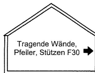
Tragende Wände, Pfeiler und Stützen sind gemäß § 5 Abs. 1 und § 9 DVNBauO mindestens feuerhemmend auszuführen.
