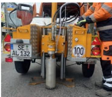
Das verwendete Fahrzeug ist so ausgestattet, dass die Auswirkungen der Maßnahmen so gering wie möglich gehalten werden. Die Ausführung der Bohrungen erfolgt mit einem VW-Crafter mit Bohranhänger mit einem Gesamtgewicht unterhalb von 6 t.
