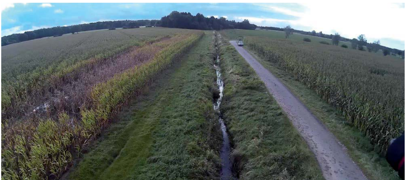
Eine beginnende eigendynamische Laufverlagerung im Gewässer sowie vernässte Flächen im unzugänglichen Maisbestand können durch Drohnenbefliegung erkannt werden. (Foto: U.A.N.)
